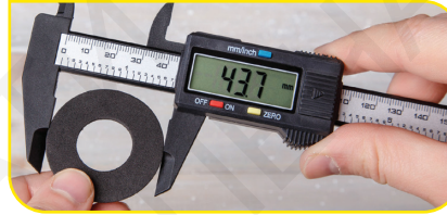
Рисунок 2.16. Измерение диаметра цифровым штангенциркулем
