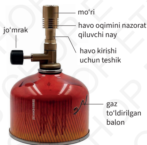
1.15-rasm. Bunzen gaz gorelkasi o'rnatilgan gaz lampasi. Ushbu jihoz laboratoriya ishlarida qizdirish maqsadida keng qo'llaniladi.
